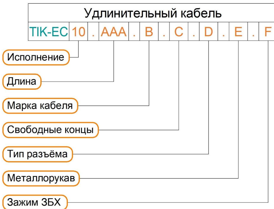
Рис. 1 – Маркировка удлинительного кабеля без муфты ТИК-ЕС10
