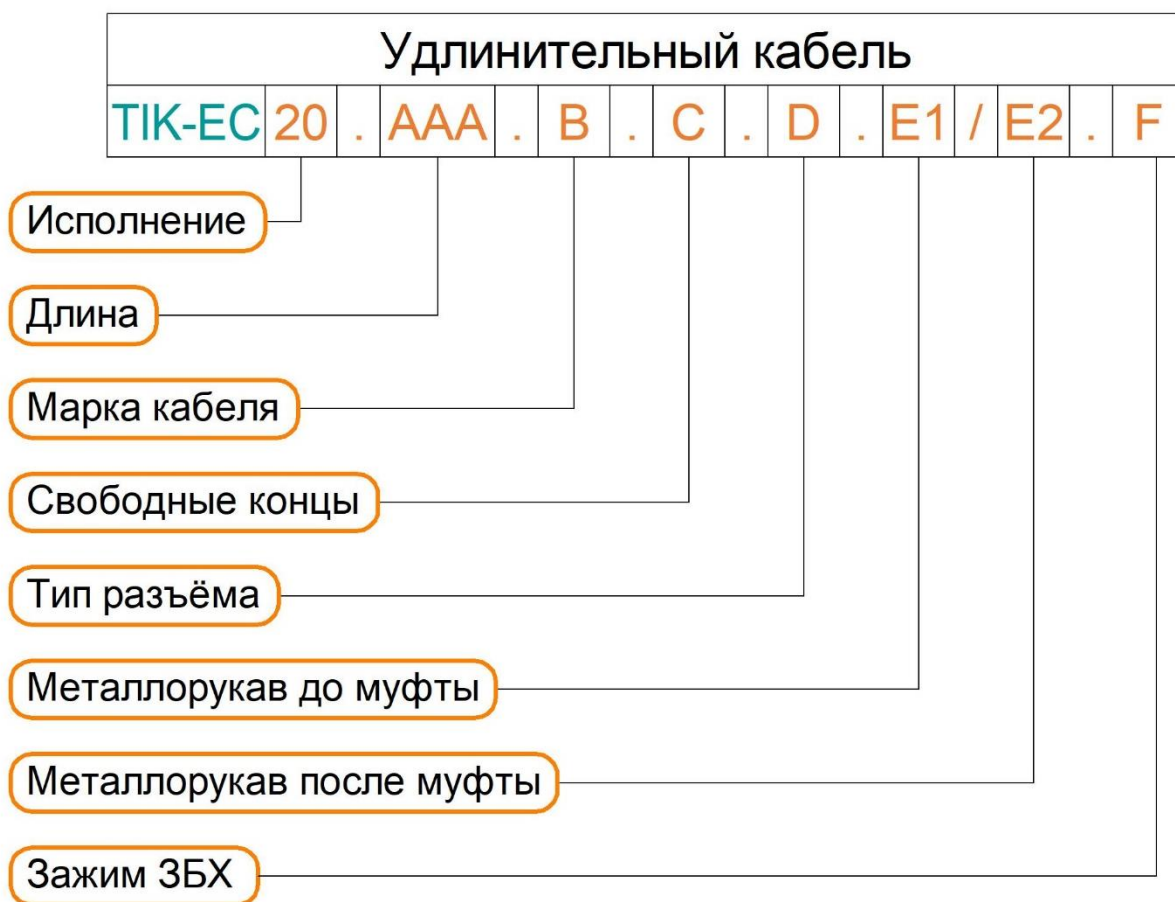
Рис. 3 – Маркировка удлинительного кабеля с муфтой ТИК-ЕС20
