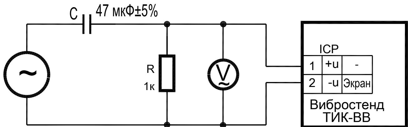
**Приложение А1. Протокол поверки измерительного канала вибропреобразователя с выходом по напряжению (ICP)**
